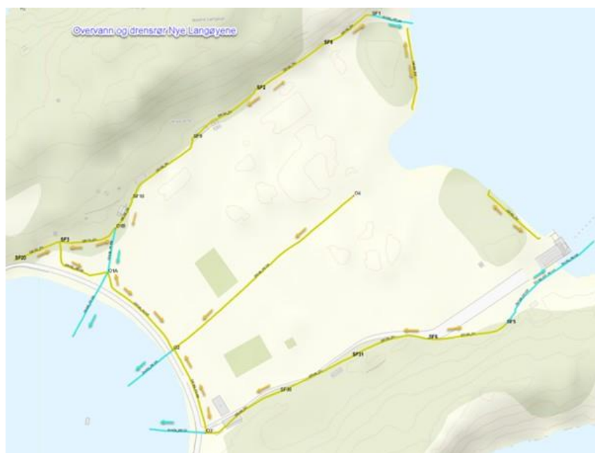
Figur 4.7: Etablert overvann og drenerør for drenering av overvann ut mot sjø, over bentonittmembran. Blå farge viser overvannsrør ut i sjø og gulgrønn farge viser drenerør som ligger i grøft. Pilene viser fallretning på rørene.
