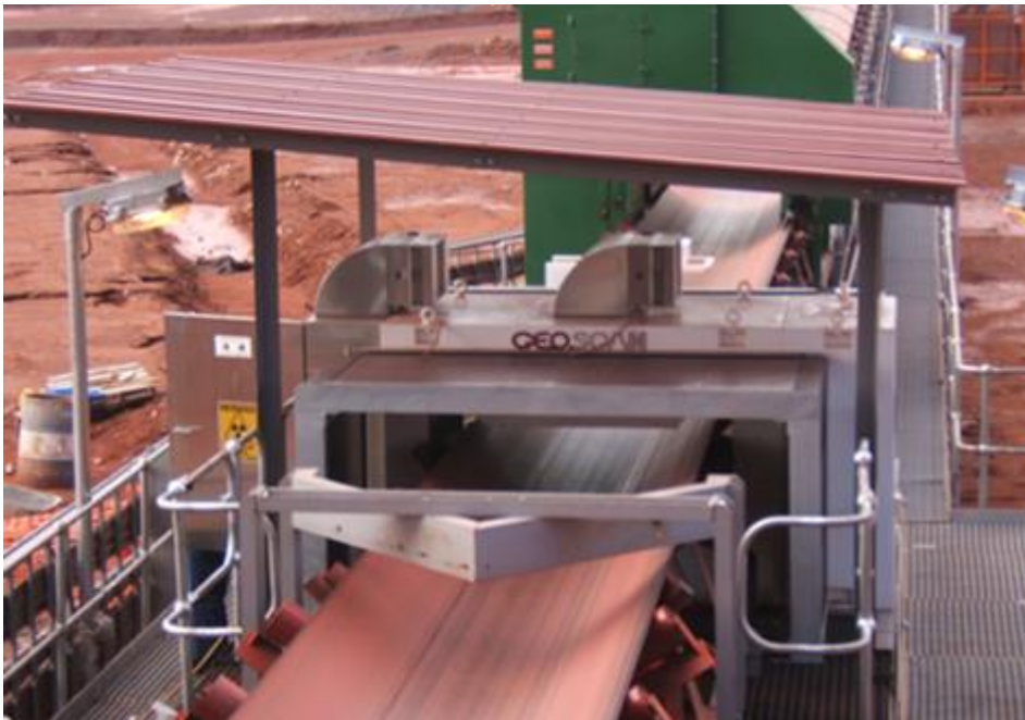
Figur 3-4: GeoScan-m, PGNAA on-line analyseverktøy produsert av Scantech.
