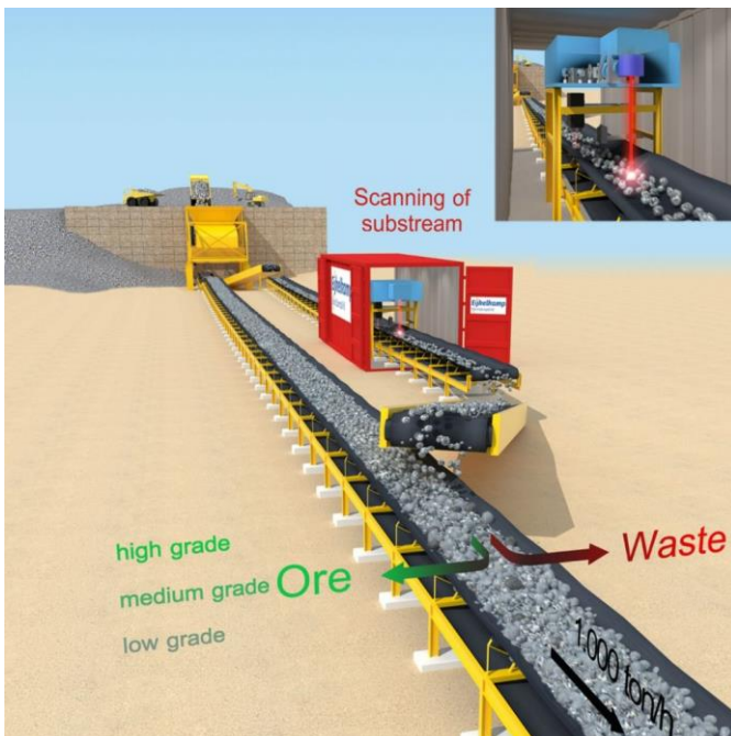
Figur 3-6: Prinsippskisse av LIBS-analyse brukt for å skille mellom malm og avfall (Eijkelkamp, u.d.) 3.3.1 Markedsoversikt
