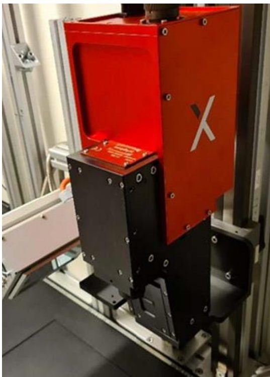
Figur 3-10 HySpex SWIR-384 montert over et transportbånd. Bilde hentet fra www.hyspex.com .
