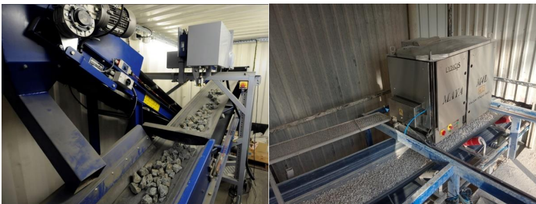
Figur 3-7: Produkter for on-line LIBS-analyse. Til venstre: SPECTRAL Conveyor Belt LIBS sensor (Spectral Industries). Til høyre: MAYA produsert av Lyncis.
