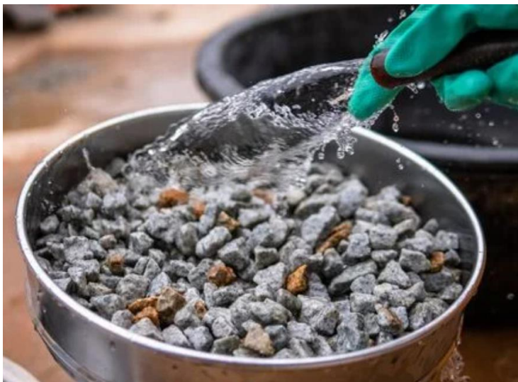
Figur 5-1 Prinsippskisse for siktetesting. Figur hentet fra www.shutterstock.com .
